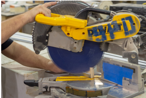
Corte perfil y esquinas con ángulo
